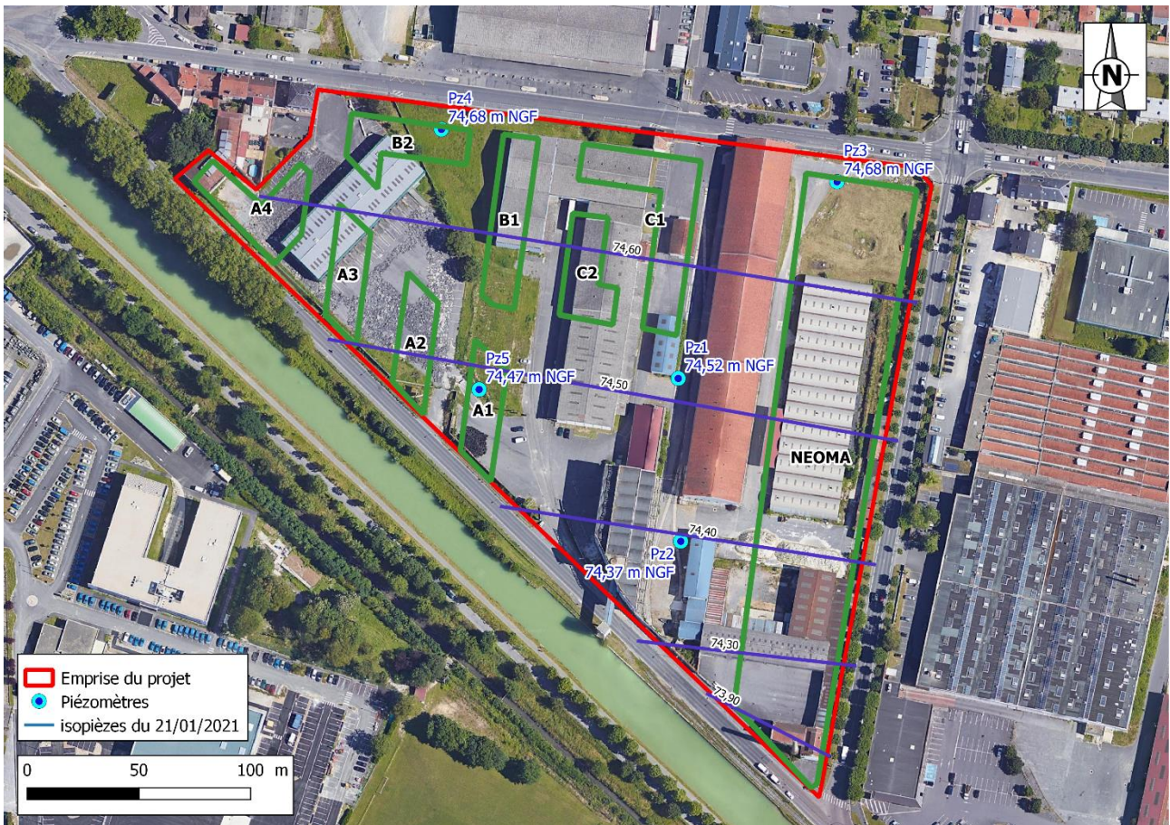
Figure 5 : Carte piézométrique du secteur d'étude, à partir des données piézométriques du 21/01/2021 (fond de carte IGN BDORTHO®)
